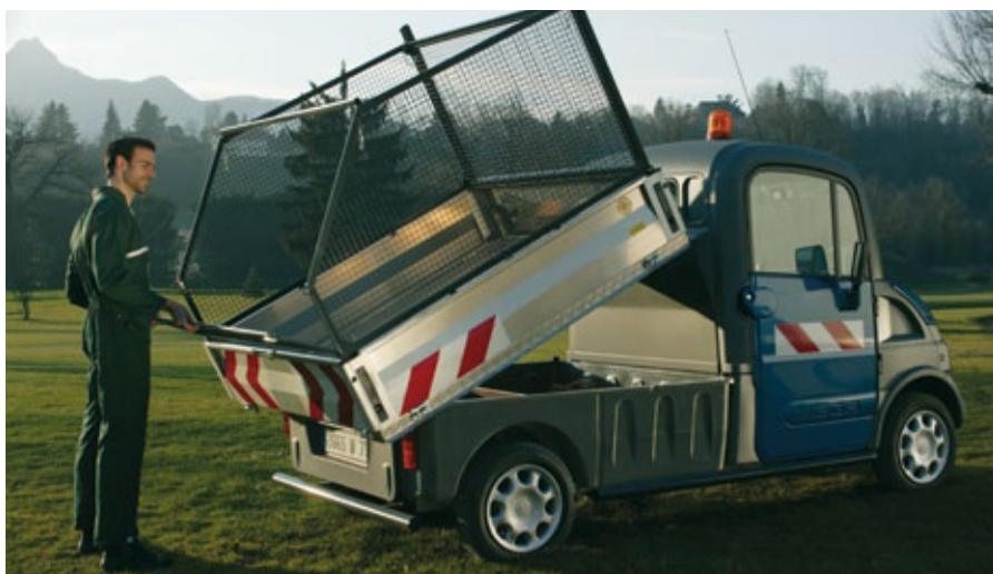
Rehausse grillagée amovible / Filet pour rehausse
