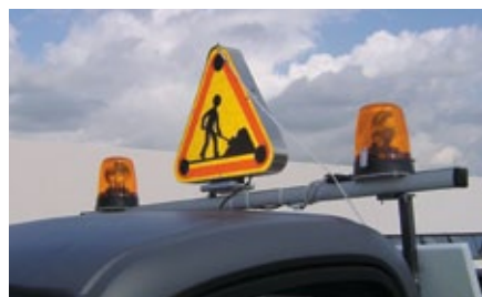
Barre de signalisation (triangle AK5 + 2 feux)
